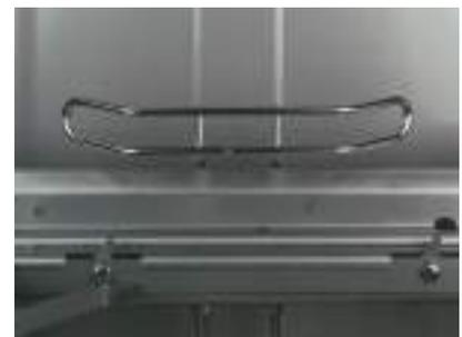
Le panier est détecté par un capteur électromécanique.
