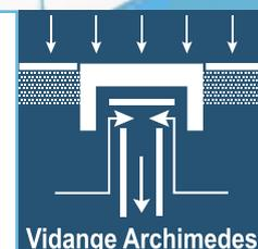
CE SYSTÈME PERMET D'UTILISER UNE CUVE DE LAVAGE DE FAIBLE VOLUME ET ÉVITE ÉGALEMENT TOUTE ÉVENTUELLE REMONTÉE D'ODEUR.
