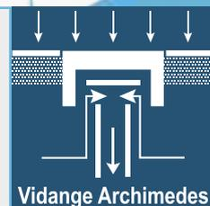
CE SYSTÈME PERMET D'UTILISER UNE CUVE DE LAVAGE DE FAIBLE VOLUME ET ÉVITE ÉGALEMENT TOUTE ÉVENTUELLE REMONTÉE D'ODEUR.
