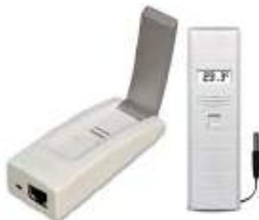
Permet de surveiller et d'enregistrer à distance la température et l'hygrométrie des chambres froides. Spécial normes HACCP. Utilisation en froid positif ou négatif.
