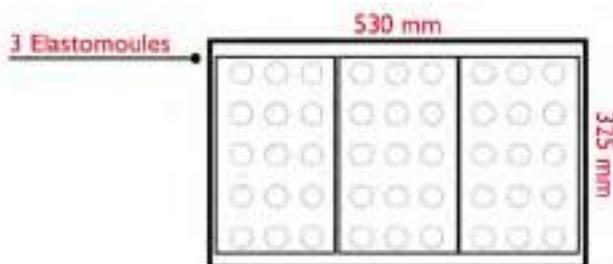
Elastomoule - 40 mini-cylindres ø 27,5 mm
